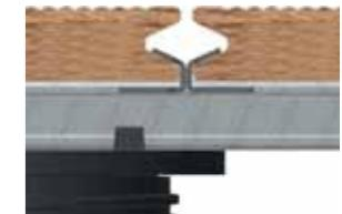
Esempio di fissaggio centrale
